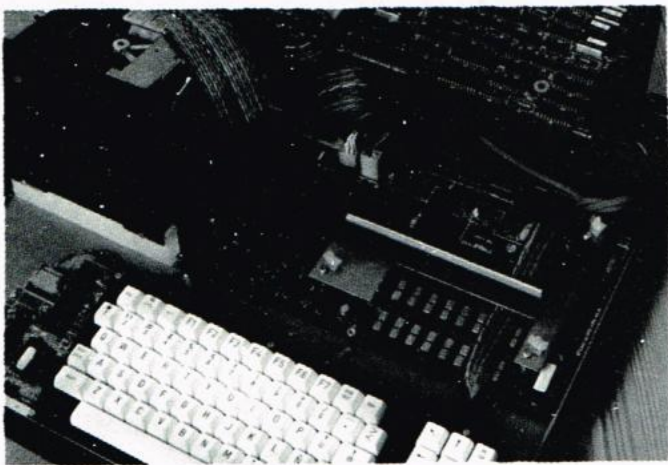
Vista interior. La tarjeta base en el centro de la ilustración. La de control del disco, en la parte superior, una vez desmontada.
